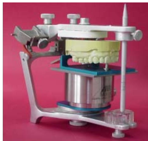
Der HIP-Mount ist eine Einrichtung, mit der auch die Position des OK-Modells relativ zur Drehachse des Artikulators exakt gesteuert werden kann.
