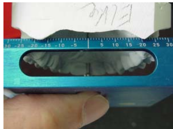
Die Referenzpunkte der HIP-Ebene dienen als Auflagepunkte auf einem Montageaufsatz des HIP-Mount.
